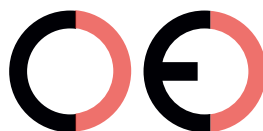
Faux marquage CE (trop éloigné)
